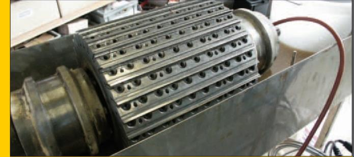
Zustand nach Reinigungsprozess mittels Ultraschall-schwingers (ca. 15-20 Minuten ohne zusätzliche mechanische Einwirkungen (Lappen, Bürsten, oder Ähnliches), Einsatz eines Zusatzstoffes mit einer Konzentration von 0,7%).
